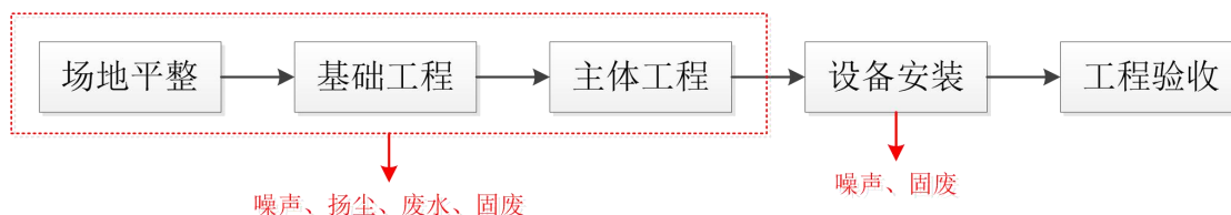
图 5-1 施工期工艺流程及产污环节图
